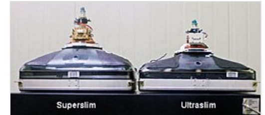
Кинескопы с углами отклонения луча 90^\circ (слева) и 110^\circ
