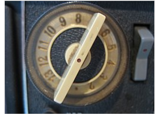
Переключатель каналов телевизора 1970-х годов
