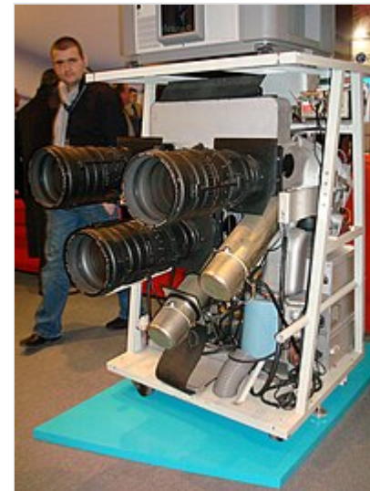
Цветной телевизионный проектор системы «Эйдофор»
