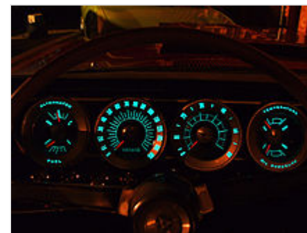
Подсветка приборной панели автомобиля электролюминесцентным излучателем
