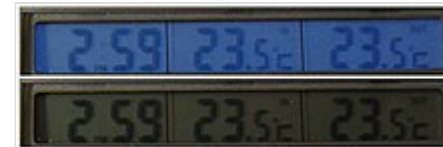
Подсветка жидкокристаллического дисплея расположенным за ней электролюминесцентным излучателем
