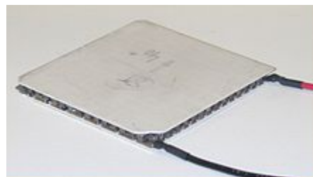
Внешний вид элемента Пельтье. При пропускании тока тепло переносится с одной стороны на другую.
