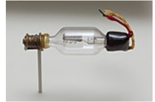
Триод («аудион») Ли де Фореста , 1906 год
