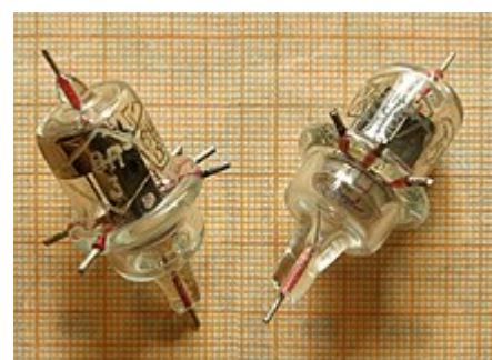
Миниатюрная лампа типа «жёлудь» (пентод 6Ж1Ж, СССР, 1955 г.).
