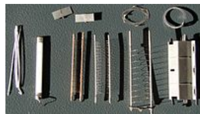
Элементы электронной лампы (пентода): нить накала, катод, три сетки, анод. Вверху — элементы крепления и кольцо с поглотителем остатков воздуха
