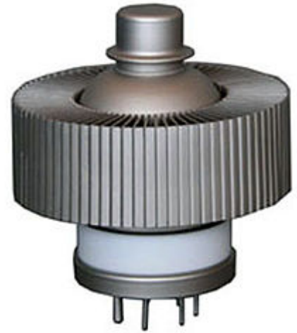
Мощный генераторный триод УКВ-диапазона с выходной мощностью 1500 Вт. На выводе анода установлен радиатор для принудительного воздушного охлаждения
