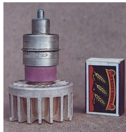
Металлокерамический генераторный триод ГС-9Б с воздушным охлаждением (СССР)
