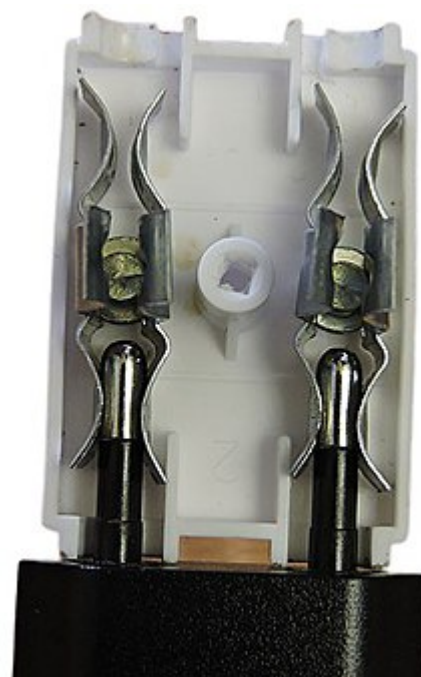
Разобранный тройник. Видны штыри его вилки, к которым прикреплены пластины, образующие скобы, в которые входят штыри электроприборов
