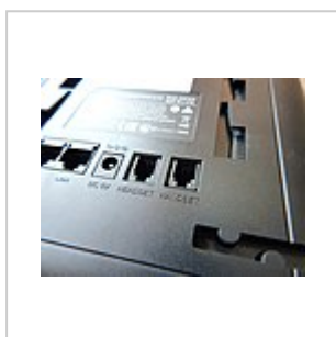
Штекеры RJ-11 и RJ-9 для подключения трубки и гарнитуры к IP-телефону по проводу
