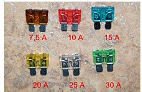
Автомобильные плавкие предохранители имеют различную окраску в зависимости от расчётной силы тока
