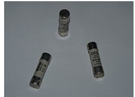
40-амперные предохранители с характеристикой срабатывания «gG», равносильные советской характеристике «ППН»
