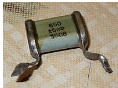
Слюдяной герметичный конденсатор в металлостеклянном корпусе типа «СГМ» для навесного монтажа
