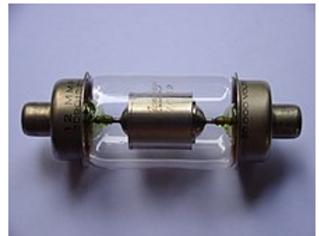
12 пФ, 20 кВ вакуумный конденсатор постоянной ёмкости с урановым стеклом у места входа в колбу выводов
