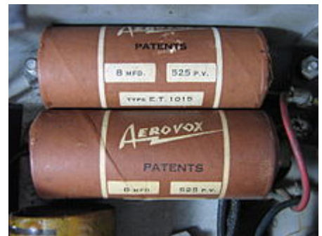
Два 8 мкФ, 525 В бумажных электролитических конденсатора в радио 1930-х годов. [10]
