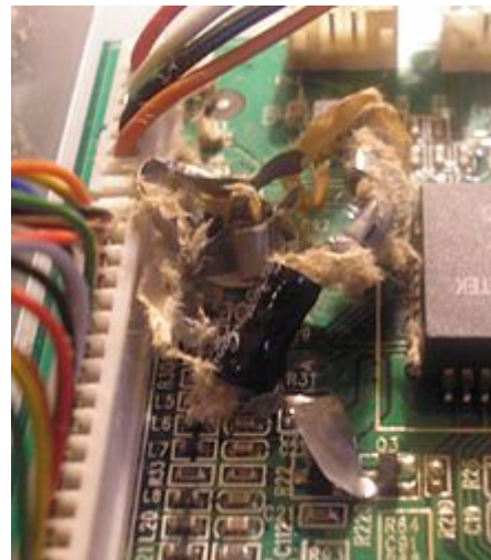
Взорвавшийся электролитический конденсатор на печатной плате жидкокристаллического монитора. Видны волокна бумажного сепаратора обкладок и развернувшиеся фольговые алюминиевые обкладки.
