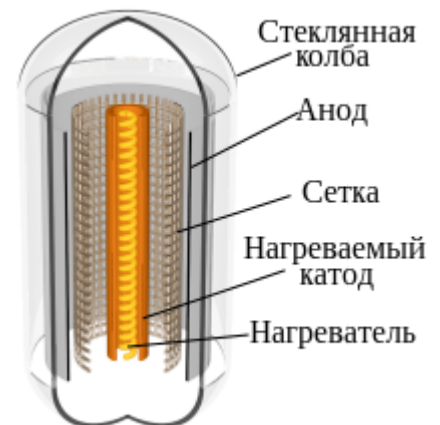
Схема вакуумного триода с катодом косвенного накала
