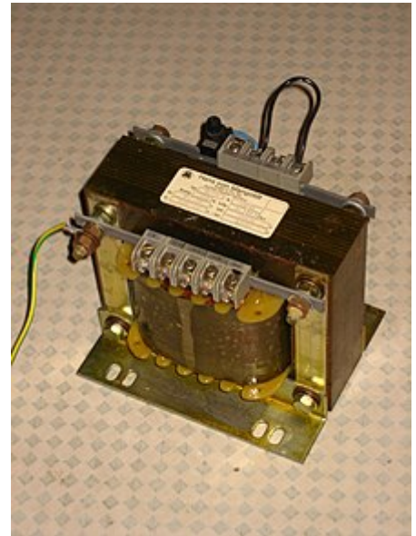
Компактный сетевой трансформатор
