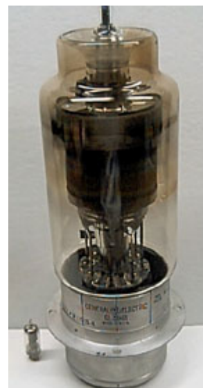
Миниатюрный тиратрон 2D21 (слева внизу, используется в контрольных цепях) и большой водородный тиратрон фирмы General Electric, используемый в импульсных радарах
