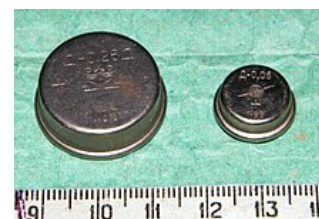
Дисковые NiCd-аккумуляторы D-0,26Д и D-0,06
