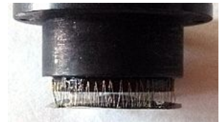
Увеличенная фотография термобатарей фотоприёмника. Каждый из проволочных уголков представляет собой термопару.
