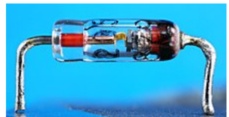
Устройство стабилитрона в стеклянном корпусе.
