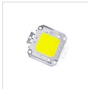
Белый COB- светодиод с мощностью 100 Вт, напряжением питания 36 В. В отличие от обычных светодиодов, состоит из множества синих светодиодов, объединённых в одном кристалле и с общим люминофорным покрытием [16]
