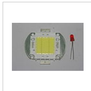
Мощный белый светодиод 20 Вт в сравнении с красным индикаторным 5 мм светодиодом
