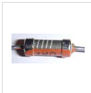
Плёночный угольный резистор (часть защитного покрытия удалена для демонстрации токопроводящего слоя)
