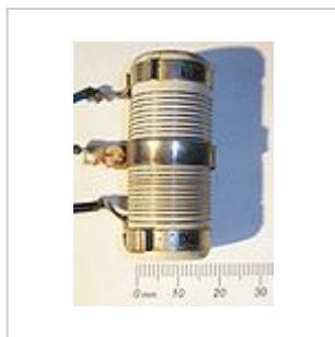
Проволочный резистор с отводом
