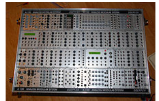
Аналоговый синтезатор на модулях EAR и Doerfer. Четвёртый и пятый модули слева в нижнем ряду — управляемые фильтры нижних частот на оптопарах Vactrol.
