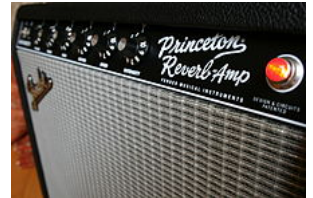
Гитарный усилитель Fender с эффектом тремоло. Крайний правый потенциометр (intensity) регулирует глубину модуляции
