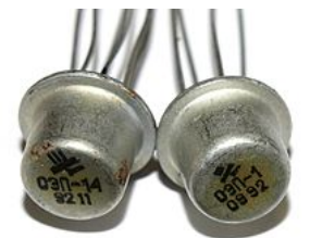
Советские оптопары в металлических корпусах допускали эксплуатацию при температурах окружающей среды от -60 °C до +55 °C.
