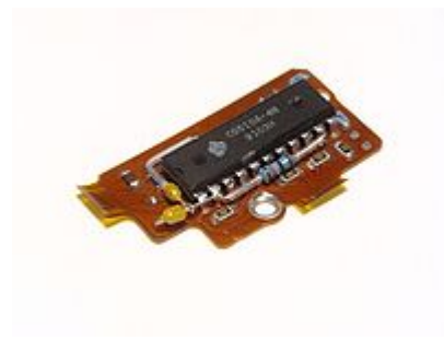
Гибкая печатная плата с установленными деталями объёмного и поверхностного монтажа
