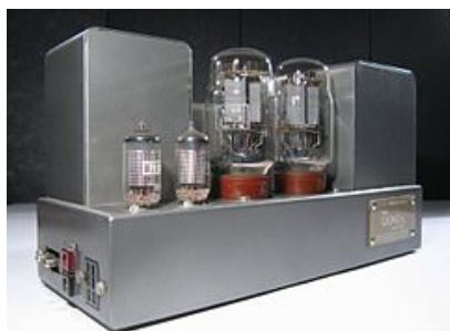
УНЧ Quad II (1958) — пример малошумящей конструкции на экранированных лампах. На переднем плане слева — балансный входной каскад на паре EF86 [93] .
