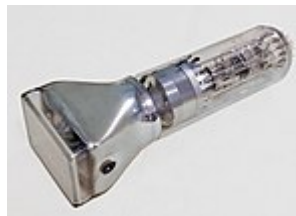
Внешний вид осциллографической электронно-лучевой трубки
