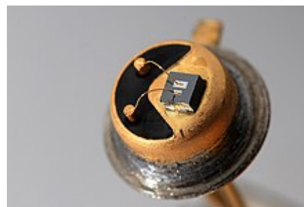
Строение транзистора 2Т117Б: Крупный контакт — эмиттер, малый контакт — Б1, нижняя сторона кристалла — Б2
