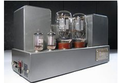
УЗЧ Quad II, выполненный по полностью балансной схеме. Первый каскад — пентоды EF86, второй каскад — лучевые тетроды КТ66. Выходная мощность 15 Вт.
