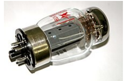
Лучевой тетрод KT66 современного производства. KT66 — первый лучевой тетрод британского производства, сменивший «лампу Харриса»
