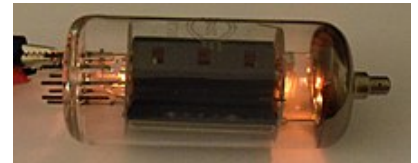
6П42С — лучевой тетрод для работы в телевизорах, в выходных каскадах строчной развёртки
