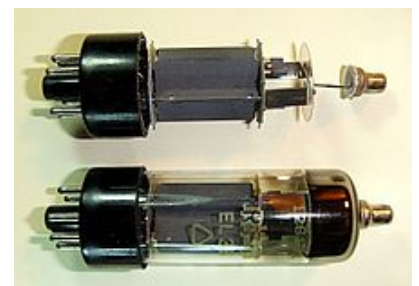
EL36 — лучевой тетрод для строчной развёртки в телевизорах
