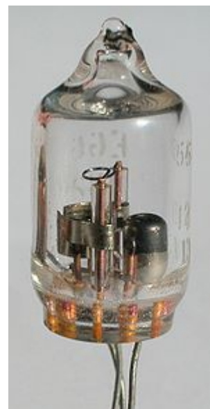
Ключ KN2 «Krytron», изготовленный EG&G — высотой примерно 25 мм
