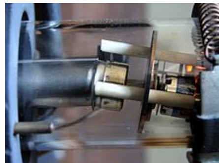
Ионная ловушка в шейке колбы кинескопа
