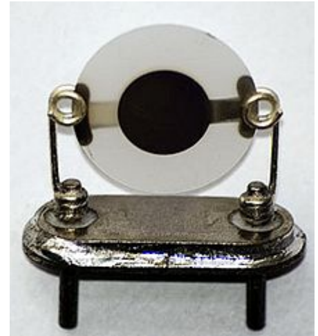
Кварцевый резонатор в кристаллодержателе
