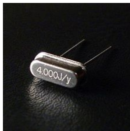
Резонатор на 4 МГц в миниатюрном металлическом герметизированном корпусе HC-49/US
