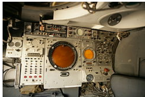
Пульт оператора ЗРК «Куб». В центре находится индикаторная ЭЛТ кругового обзора (ИКО).
