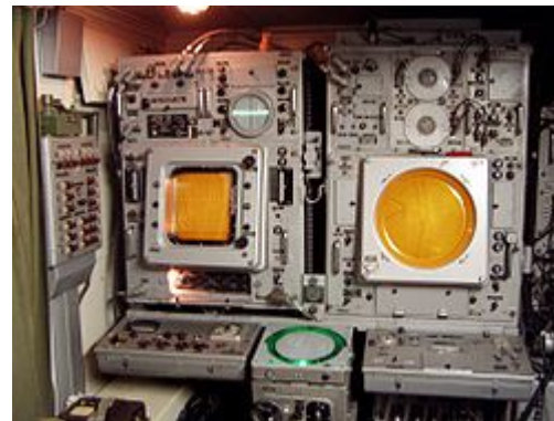
Индикаторные трубки различных типов. На правом индикаторе кругового обзора (ИКО; англ. plan position indicator , PPI) видно оптически спроецированное изображение плана местности.
