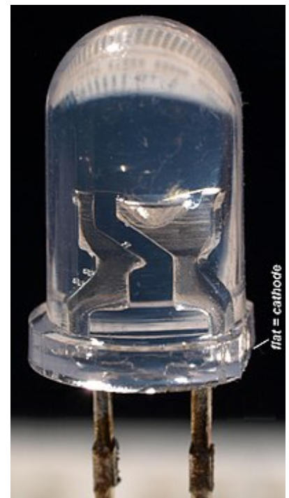
Светодиод ультрафиолетового излучения (увеличен). Катод справа, рядом с плоским срезом на корпусе.
