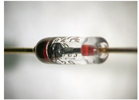
Полупроводниковый диод в стеклянном корпусе. На фотографии виден полупроводник с подходящими к нему контактами
