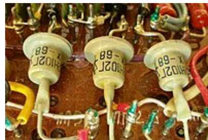
Динисторы типа 2N102Г производства СССР на плате
