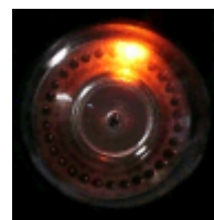
Декатрон в процессе счёта
