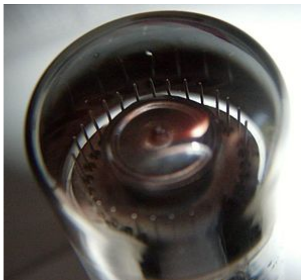
Анод (в центре), катоды и подкатоды декатрона
