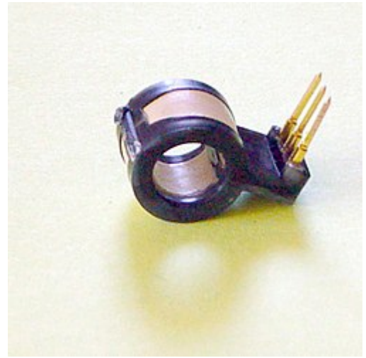
Датчик тока на эффекте Холла с внутренним усилителем на интегральной схеме. Отверстие 8 мм. Выходное напряжение при нулевом токе находится посередине между напряжениями питания, которые поддерживают дифференциал от 4 до 8 вольт. Отклик на ненулевой ток пропорционален подаваемому напряжению и линеен до 60 ампер для данного конкретного устройства (25 А).
