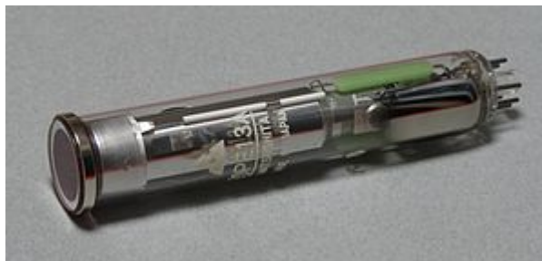
Видикон диаметром 2/3 дюйма фирмы «Matsushita»
