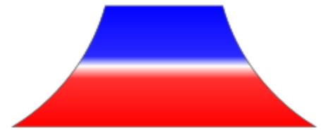
При низком напряжении на р-п переходе толщина обеднённого слоя мала, ёмкость высока
