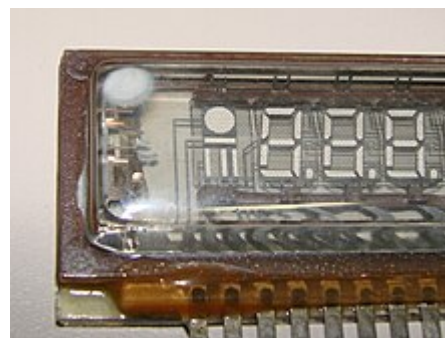
Белое пятно сигнализирует о нарушении герметичности колбы индикатора
