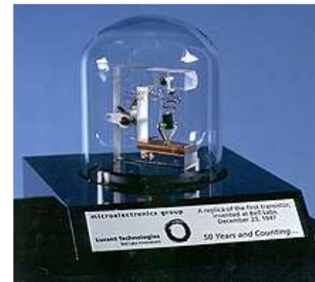
Копия первого в мире работающего транзистора
