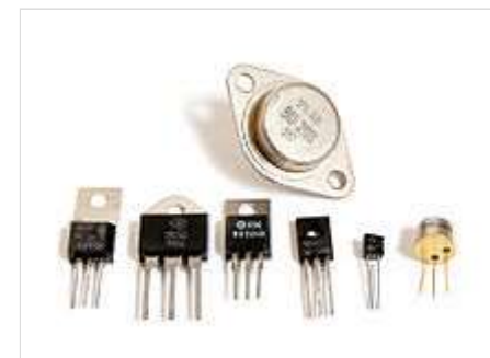
Дискретные транзисторы в различном конструктивном оформлении
