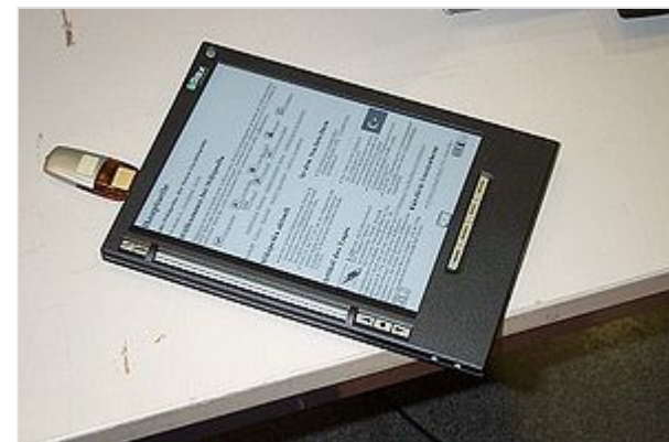
Электронная книга — устройство, в котором используется электронная бумага
