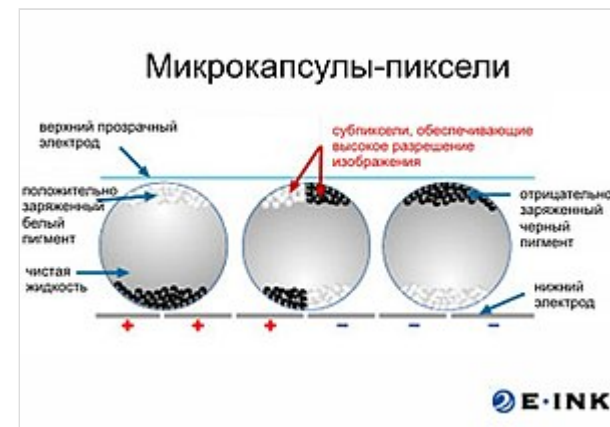
Принцип действия «электронных чернил»
