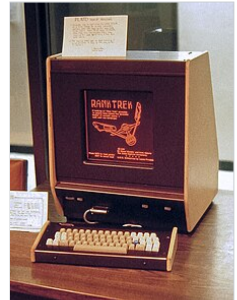
Оранжевая монохромная индикаторная панель Digivue в PLATO V , 1981
