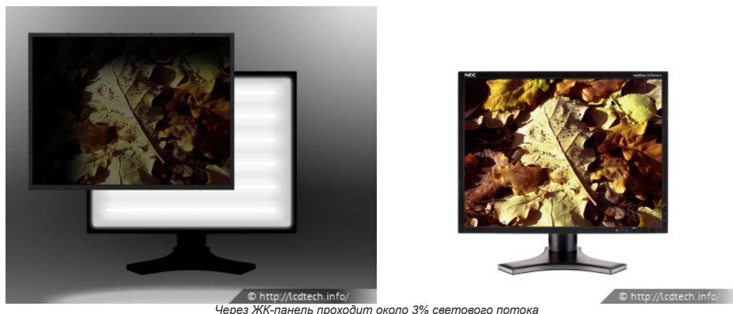
Через ЖК-панель проходит около 3% светового потока
