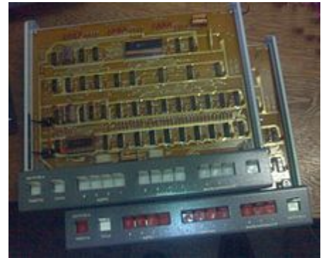
Два тренажёра программирования 4-разрядной микропроцессорной секции КР1804BC1 (аналог Am2900) "Микротренажёр МТ1804".
