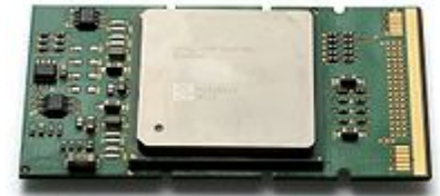
Процессор Itanium 2 в корпусе PAC — один из представителей VLIW-архитектур
