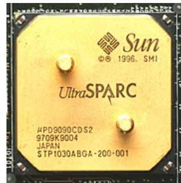
RISC-микропроцессор UltraSPARC компании Sun
