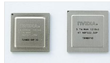
NVIDIA Tegra T20 (Tegra 2, слева) и NVIDIA Tegra T30 (Tegra 3, справа)
