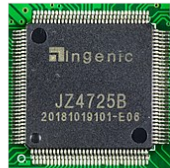
Ingenic JZ4725 — пример SOC, базированной на MIPS
