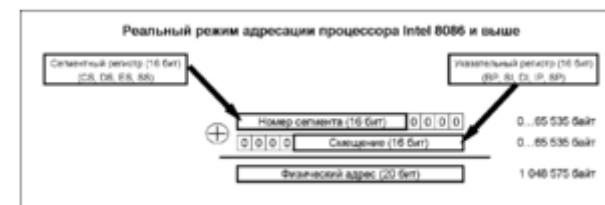
Схема, показывающая работу реального режима адресации процессора Intel 8086 и выше
