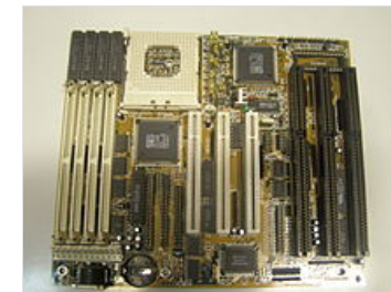
Материнская плата на чипсете SIS (85C496 и 85C497) для процессоров класса i486
