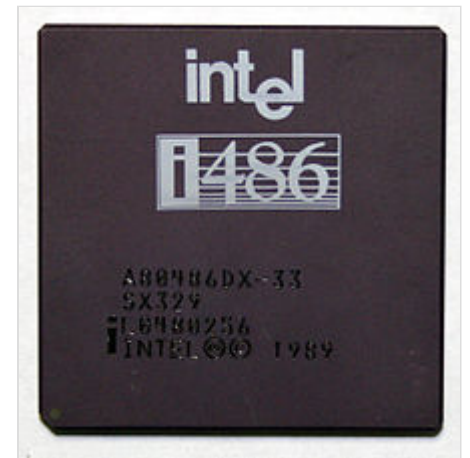
микропроцессор Intel 80486DX-33. Тактовая частота 33 МГц
