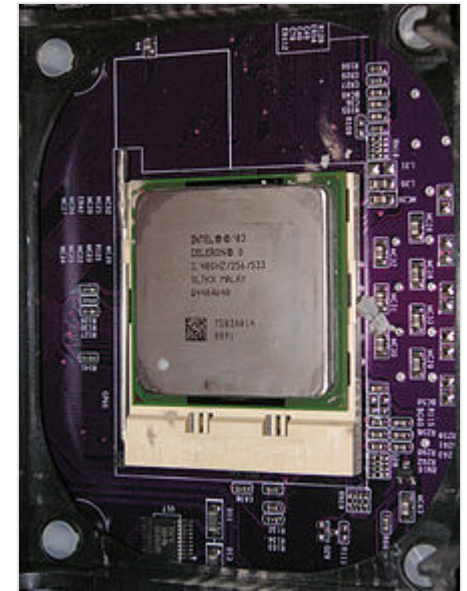
Процессор Intel Celeron D, частота 2,4 ГГц. Расположен в соquete mPGA478B (платформа Socket 478 )
