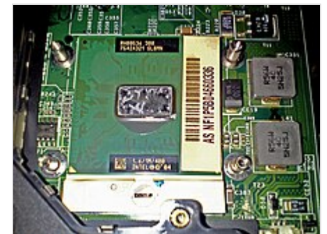
Intel Celeron-M, установленный в Socket 479
