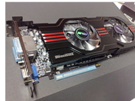
Пример 2x-слотовой карты PCIe с активным охлаждением.
