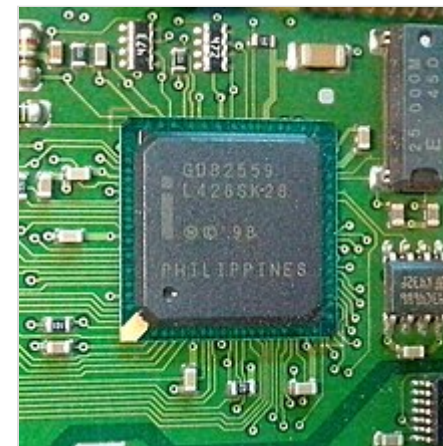
Микроконтроллер (интегрированной сетевой карты) Intel 82559
