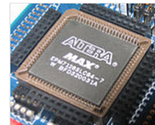
ПЛИС типа CPLD компании «Altera», модель «MAX 7128»
